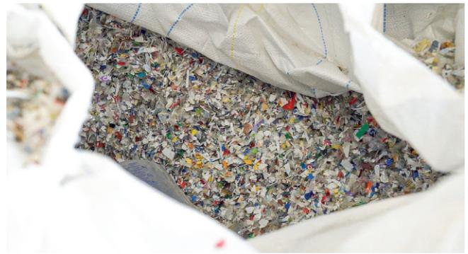
Bild 2: Mischung von PP Flakes (PCR)
